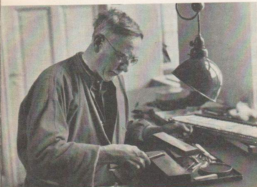
Här se vi en av de gamla yrkesskickliga smederna hos Heljestrands i arbe- te. Han ger en av de berömda rakkni- varna en sista av- slipning.
